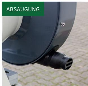
Absaugstutzen für Absauganlage.
