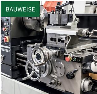
Lange Schlittenführung zur Aufnahme enorm hoher Schnittkräfte
