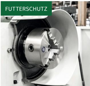
Bruchfester, massiver und drehbar gelagerter Futterschutz.
