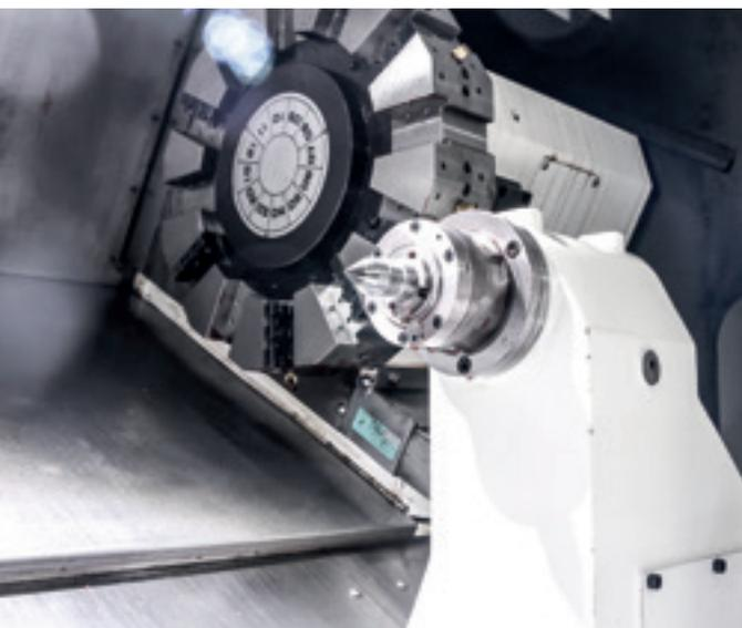
Der hochstabile Reitstock wird über einen Servomotor angetrieben und verringert durch seine hohen Eilgang- und Vorschubgeschwindigkeiten die Einrichtzeit.
