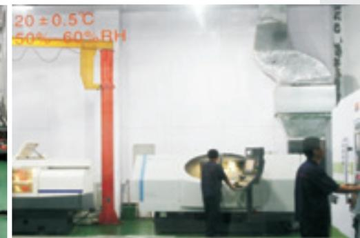
Anpassung der Hauptspindel mit Kellenberger CNC-Rundschleifmaschinen unter klimakontrollierten Bedingungen.
