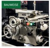
Lange Schlittenführung zur Aufnahme enorm hoher Schnittkräfte
