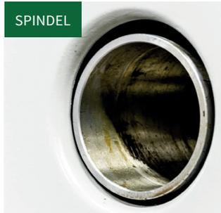
103 mm Spindelbohrung
